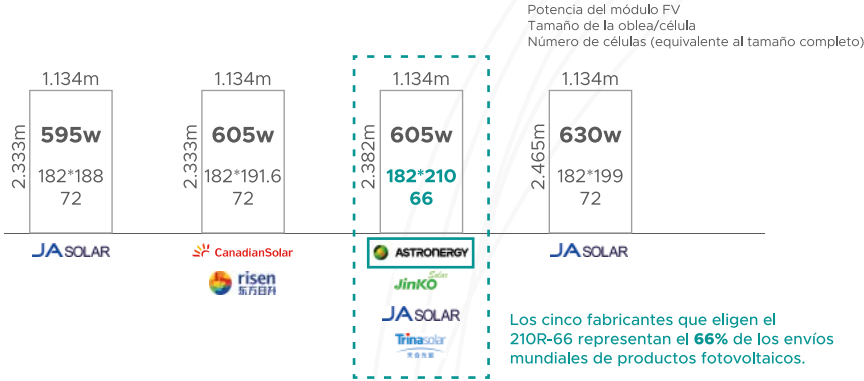
Figura 11: Obleas rectangulares adoptadas por los principales fabricantes.
